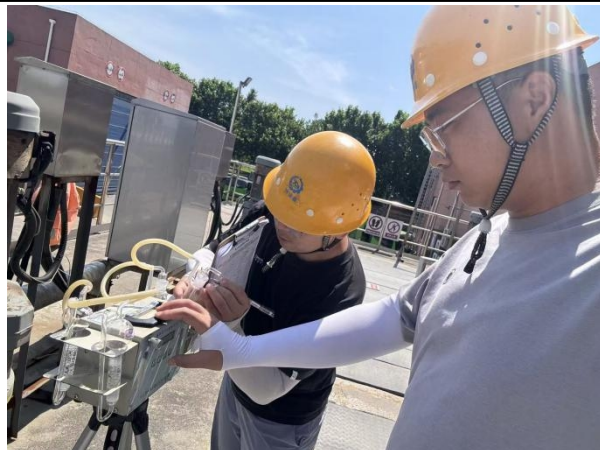
贮泥池处毒物采样
