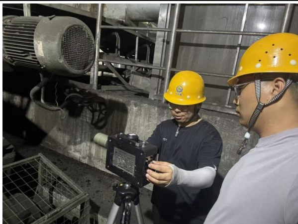
板框污泥输送皮带处粉尘测量
