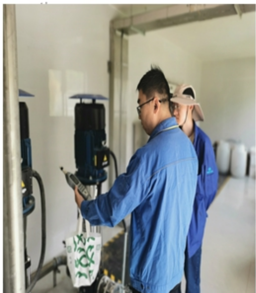
中压冲洗水泵间噪声检测
