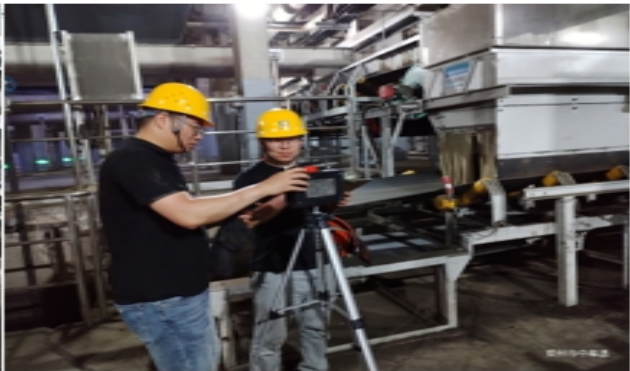
板框区输送皮带处粉尘采样
